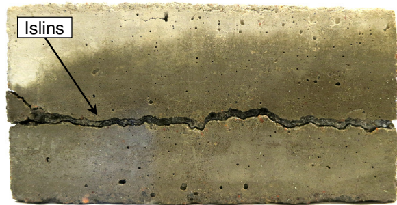
Figur 9. Provkropp som har delats av en islins.
